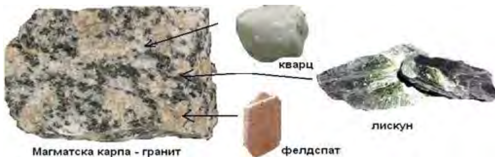
Слика 2. Минерален состав на гранит
