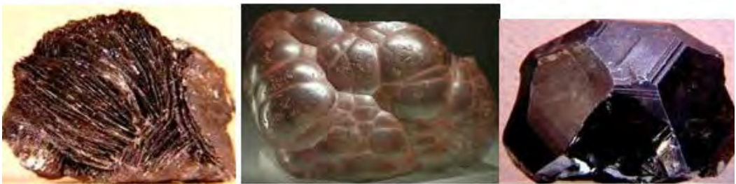
Слика 74. Начин на појавување на хематит: лушпест, бубрежаст и кристален
