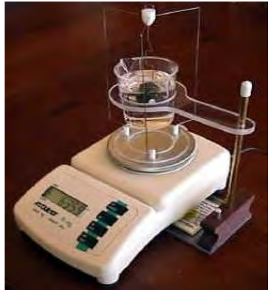
Слика 14. Електронска вага за мерење на специфична тежина
